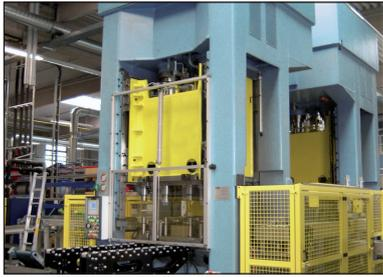
Fig. 1 - Metalforming press
