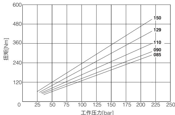
注: 上图中的值是指操作每个泵芯所需的扭矩。施加在泵轴上的总扭矩由每个泵芯 (第一级泵+第二级泵) 的扭矩之和得出
