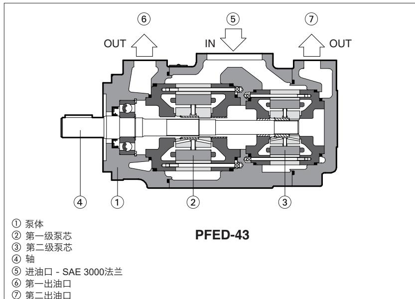
**PFED** 是定排量双联叶片泵，由两个泵芯②③组装在同一泵体中，共用一个进油口⑤且有两个独立的出油口⑥⑦。
