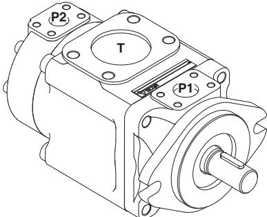
双联泵可在相对于驱动轴的不同方向布置油口, 第一级泵的油口位置说明如下 (从轴端看) :
