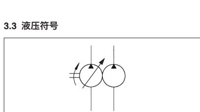
PVPCX2E是由一台PVPC型变量轴向柱塞泵和一台PFE型叶片泵组成的双联泵。它们有两个独立的进油口和两个独立的出油口。
