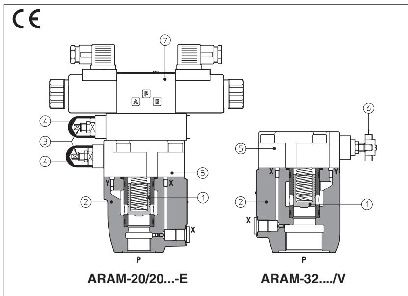
ARAM是锥阀式, 带螺纹接口管式安装的两级溢流阀。
