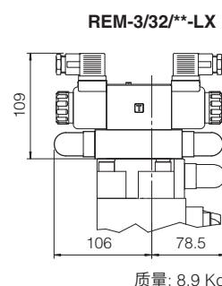
直流电压, 带666插头阀的外形尺寸
