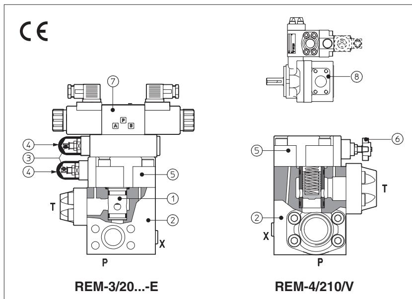
REM是锥阀式两级法兰连接的溢流阀, 适用于液压系统中。
