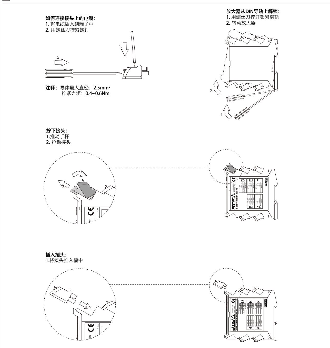
注释：所有的接头提供机械编码，此特性保证每个接头对应唯一的插槽。
