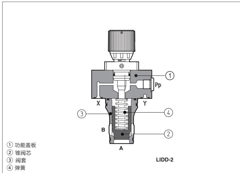
LIDD 为无补偿流量控制阀，ISO标准插装式设计，由一个功能盖板①和一个2通SC LI插件组成。
