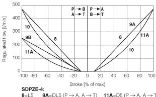
**8**=L5 **9A**=DL5 (P $\rightarrow$ A, A $\rightarrow$ T) **11A**=D5 (P $\rightarrow$ A, A $\rightarrow$ T) **10**=S5 **9B**=DL5 (P  $\rightarrow$  B, B  $\rightarrow$  T) **11B**=D5 (P  $\rightarrow$  B, B  $\rightarrow$  T)
