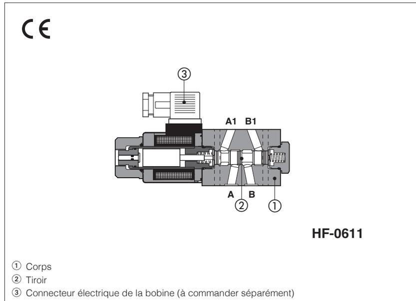
Les valves **HF** sont à tiroir, à commande par solénoïde en version modulaire, généralement utilisées pour la fermeture ou la dérivation de lignes hydrauliques.
