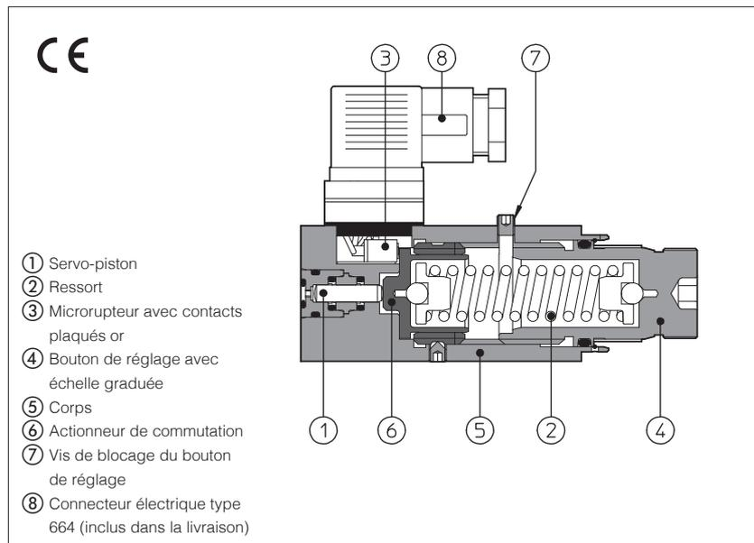
Les **MAP** sont des pressostats hydroélectriques à pression différentielle fixe de commutation. Le microrupteur mécanique avec contacts plaqués or garantit une grande fiabilité et une longue durée de vie.
