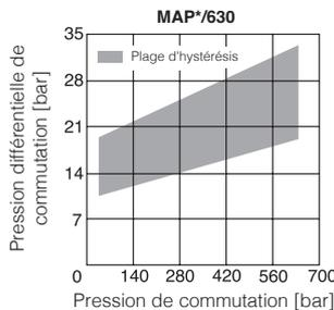
Les diagrammes montrent la différence de pression de commutation (hystérésis) entre les positions de commutation des contacts électriques du pressostat.
