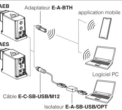
**AVERTISSEMENT :** le port USB de la carte n'est pas isolé ! Pour le câble E-C-SB-USB/M12, l'utilisation d'un adaptateur d'isolation E-A-SB-USB/OPT est fortement recommandée pour la protection du PC
