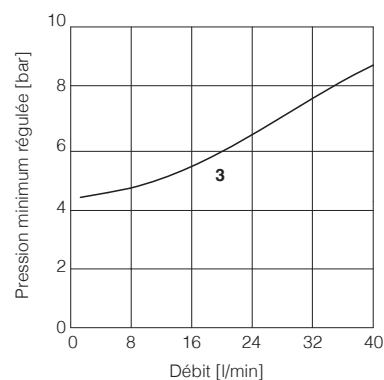
**Note:** la présence d'une contre-pression à l'orifice T peut affecter la régulation de la pression et la pression minimale
