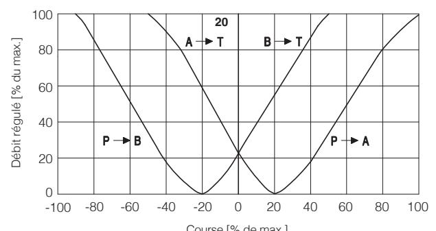
**Note :** Configuration hydraulique en fonction du signal de référence (standard et option /B)
