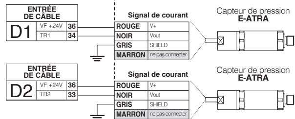
Connecter les câbles des capteurs au bornier de la carte électronique
