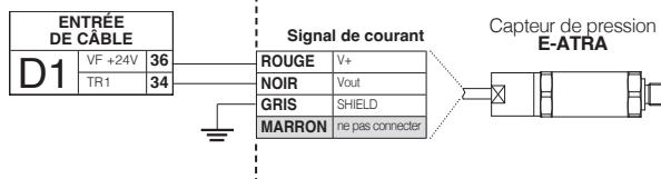
Connecter le câble du capteur au bornier de la carte électronique
