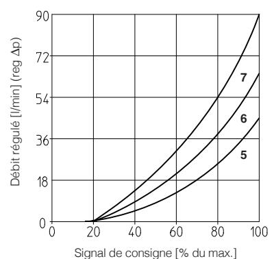
**14.2 Diagrammes débit régulé/pression de refoulement avec pression d'aspiration = 210 bar**
