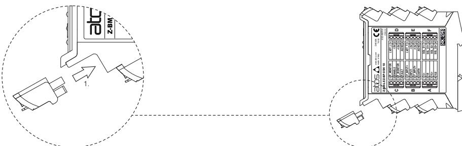
Note : tous les connecteurs sont fournis avec un codage mécanique. Cette caractéristique garantit une insertion unique de chaque connecteur dans son propre emplacement. (par exemple, le connecteur A ne peut pas être inséré dans l'emplacement du connecteur B, C, D, E, F, G, H, I, J, K)
