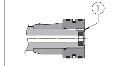
Lf ist die Gesamtlänge der Endlagendämpfung. Wenn die Endlagendämpfungen als Sicherheitseinrichtung verwendet werden, um den Zylinder und das System mechanisch zu schützen, ist es ratsam, den Hub des Zylinders um den Betrag der Endlagendämpfung Lf länger als den Arbeitshub zu wählen; auf diese Weise beeinflusst die Endlagendämpfung die Bewegung während des Arbeitshubs nicht.
