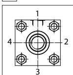
**VORDERER KOPF:** **B1** = Position des Ölanschlusses; **E\*** = Position der Endlagendämpfungen **HINTERER KOPF:** **X1** = Ölanschluss Position.
