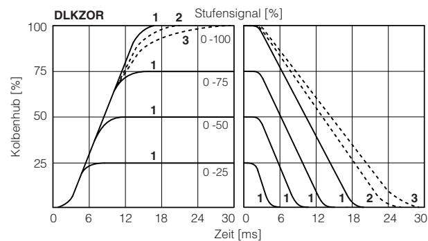
(\*) Die Ansprechzeit wird nur für den Schritt von 0-100 % dargestellt; bei Zwischenschritten ist die Zunahme der Ansprechzeit der Voreinstellungen 2 (ausgeglichen) und 3 (sanft) im Vergleich zur Voreinstellung 1 (dynamisch) proportional zur Schrittamplitude des Referenzeingangssignals
