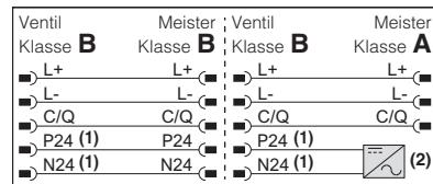
(1) Maximale Leistungsaufnahme: 50 W
