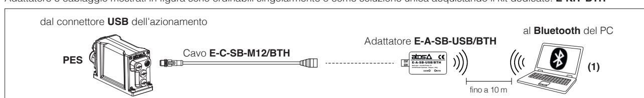
(1) Se il PC non è dotato di Bluetooth integrato, utilizzare la connessione standard tra USB e dongle Bluetooth compatibile con le specifiche E-A-SB-USB/BTH (consultare la guida AVVIO-BLUETOOTH)
