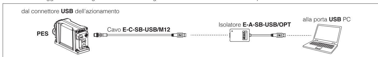
**AVVERTENZA:** la porta **USB** degli azionamenti non è isolata e l'utilizzo dell'adattatore per isolatore **USB** è caldamente raccomandato!
