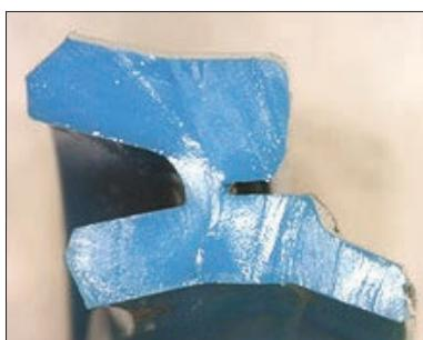
**Descrizione del problema:** il restringimento eccessivo del flusso nel circuito idraulico o urti meccanici dello stelo possono determinare picchi di pressione che sollecitano le guarnizioni dello stelo dando luogo ad una rapida usura delle guarnizioni e perdite d'olio. Le guarnizioni presentano usura anomala e, nel peggiore dei casi, estrusioni.
