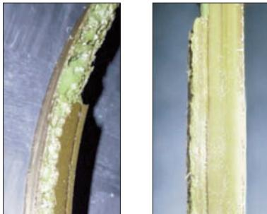
**Descrizione del problema:** velocità stelo e frequenze elevate riducono la capacità di lubrificazione delle guarnizioni e determinano l'aumento dell'attrito e della temperatura superficiale causando l'usura prematura delle guarnizioni. Questo problema è legato principalmente alle guarnizioni in poliuretano **G1** che sopportano una velocità massima di 0,5 m/s.
