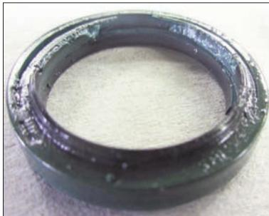
**Descrizione del problema:** la presenza di additivi aggressivi nel fluido è una delle principali cause di deterioramento della mescola delle guarnizioni che determina forti perdite. Le guarnizioni possono apparire appiccicose o secche a seconda della reazione chimica.
