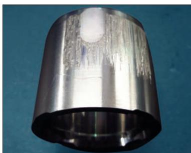
**Descrizione del problema:** il fluido contaminato è una delle principali cause di perdite dalle guarnizioni. La contaminazione da particelle abrasive è evidenziata da graffi e da rigature sulle guarnizioni, sulla bussola guida e sul pistone di frenatura, con conseguente perdita d'olio e compromissione dell'effetto frenante che mettono il cilindro fuori uso.
