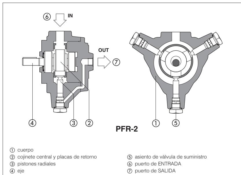
Las **PFR** son bombas de pistones radiales de desplazamiento fijo con construcción de accionamiento positivo de los pistones ③ (sin muelle de retorno) para un alto rendimiento y un bajo nivel de ruido.
