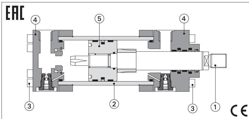
Los cilindros CNX se derivan de las norma CN (tab. B180) con construcción de acero inoxidable para soportar condiciones ambientales extremas y corrosivas y garantizar la compatibilidad con fluidos a base de agua o agua pura.
