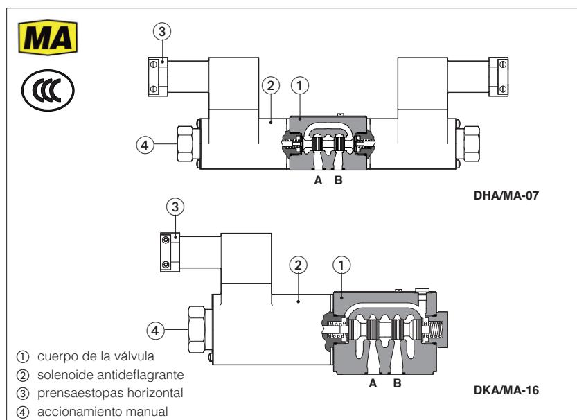
Válvulas direccionales On-off equipadas con solenoides antideflagrantes certificados según **CCC** y **MA** Certificación minera china, modo de protección:
