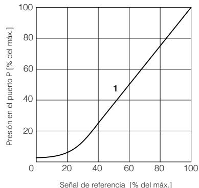
**2 Diagramas de presión/caudal** con señal de referencia ajustada a  $Q = 1 \text{ l/min}$
