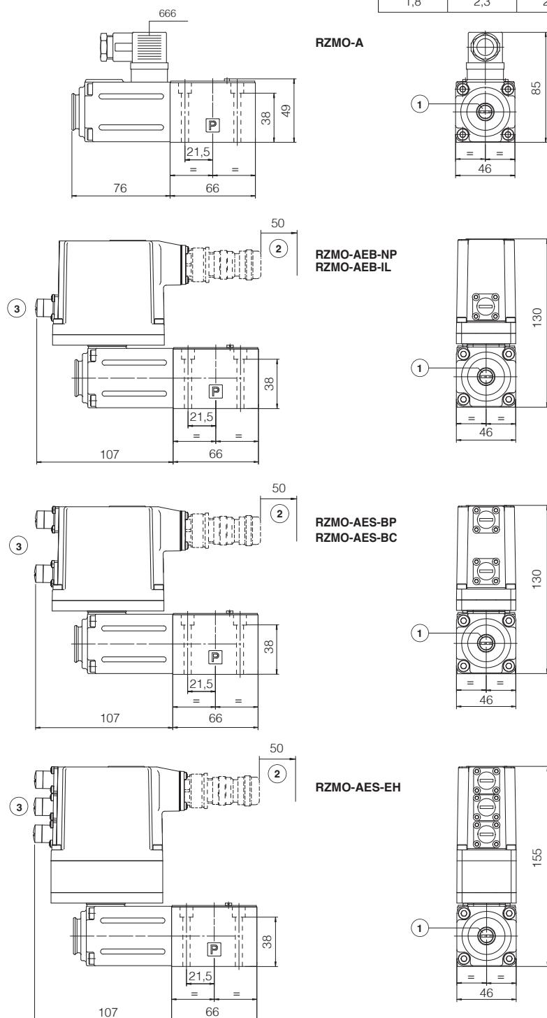
(1) = Purga de aire, consulte la sección 16 = Espacio necesario para el cable de conexión y para la extracción del conector
