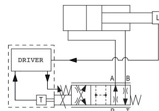
debe instalarse un transductor de célula de carga entre el actuador y la carga controlada. La opción SL controla directamente la fuerza del actuador
