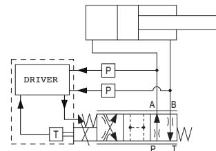
deben instalarse dos transductores de presión remotos en las conexiones A y B del actuador. Las dimensiones del orificio y el vástago del actuador deben introducirse en el software de la válvula, que calcula las áreas pertinentes: A1 = superficie del orificio; A2 = superficie del anillo La opción SF controla directamente la fuerza del actuador (F) como resultado del siguiente cálculo:  $F = (P_a \times A1) - (P_b \times A2)$
