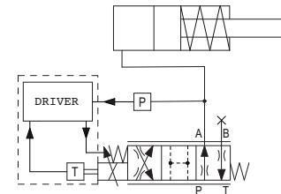
debe instalarse un transductor de presión remoto en el puerto del actuador que se va a controlar. En este ejemplo, la opción SP regula la presión en la conexión A
