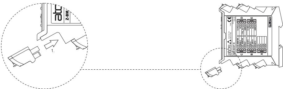
**Nota:** todos los conectores se suministran con una codificación mecánica. Esta característica garantiza una inserción única de cada conector en su propia ranura (por ejemplo, el conector A no puede insertarse en la ranura del conector B, C, D, E, G, H, I, J, K)
